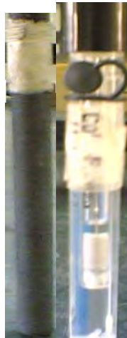
Fig. 2.6 electrodo auxiliar (izquierda) y electrodo de referencia (derecha).
