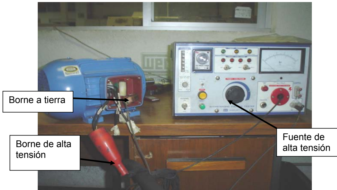
Figura 4.8 Prueba de potencial aplicado al motor de 2HP
