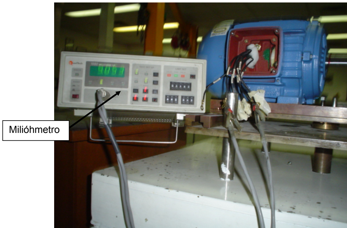
Figura 4.6 Medición de la resistencia con el milióhmetro.
