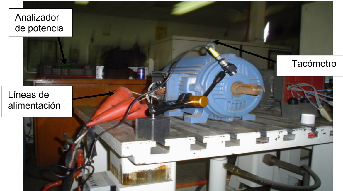
Figura 4.9 Prueba de funcionamiento en vacío al motor de 2HP
