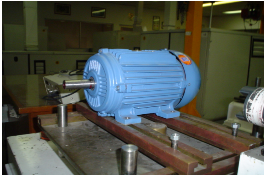
Figura 4.1 Motor de 2 HP utilizado para la realización de pruebas
