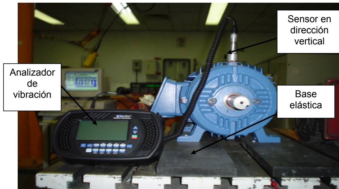
Figura 4.11 Medición de vibración en dirección vertical del lado flecha.
