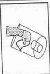
Limpie el polvo que se encuentra en el tubo de salida de aire, con un trapo humedo en donde se inserta el Elemento Filtro de Aire. Verifique que no quede nada de polvo en el perimetro del tubo, ni en el interior de la carcaza.
