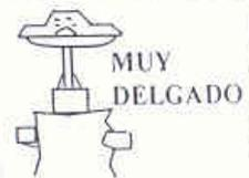
3.- Asegúrese que el filtro tenga la suficiente capacidad de filtración para el motor y que los tubos de admisión sean del mismo tamaño de la salida de aire del filtro.
