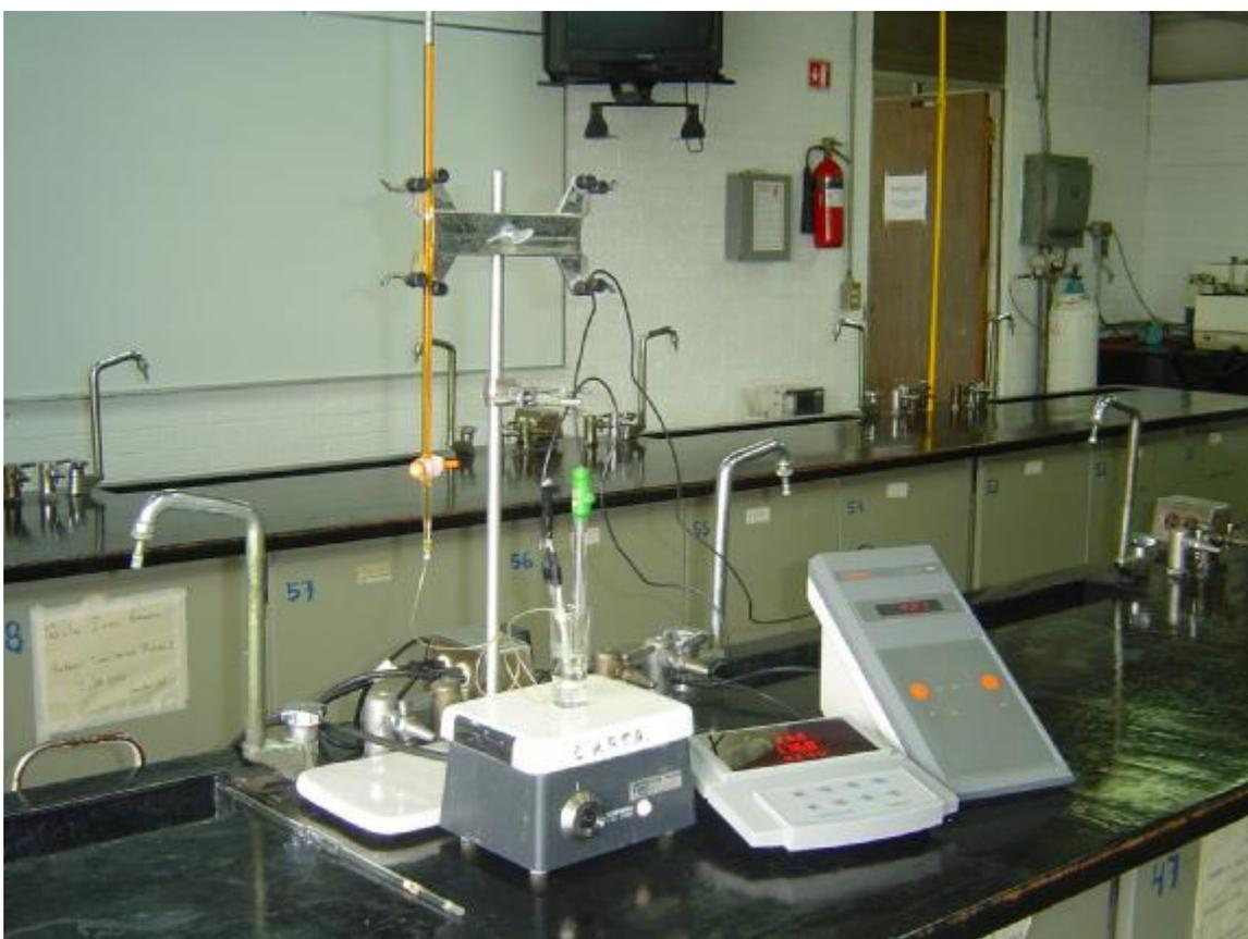
**Figura 7. Fotografía del montaje experimental para la valoración redox de  $\text{FeSO}_4$  con  $\text{K}_2\text{Cr}_2\text{O}_7$**
