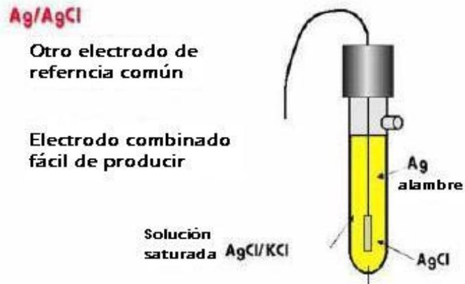
Figura 2. Electrodo de referencia de  $\text{Ag}^\circ/\text{AgCl}$
