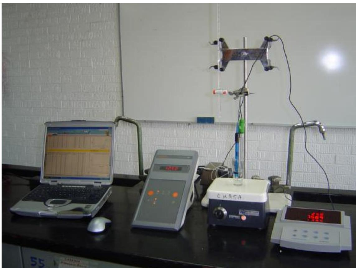
Figura 5. Fotografía del montaje experimental para la valoración de KOH con HCl
