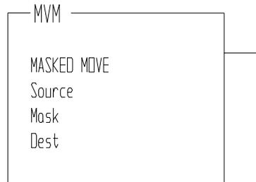
Fig. 3.20.2.- Instrucción transferencia de datos a través de una máscara.
