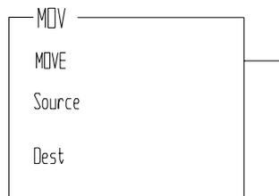
Fig. 3.20.1.- Operaciones de transferencia de datos.
