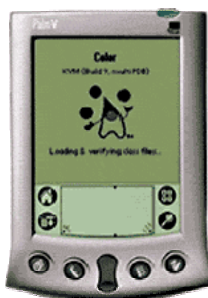
Fig 4.1 Máquina virtual de Java ejecutando un programa en el emulador de Palm.
