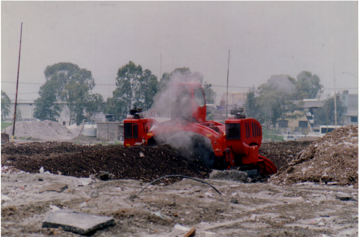
Sitio de disposición final Neza II. Máquina volteadora o aireadora para la realización de composta
