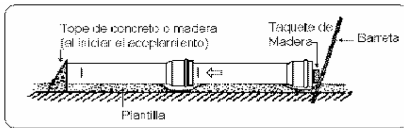
4.10. Instalación y acoplamiento de la tubería
