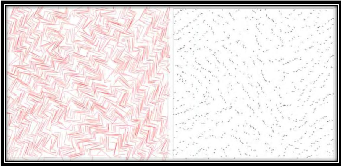
Ilustración 4.12 Imagen del sistema antes de equilibrarse en la mesofase esméctica, como puede apreciarse las moléculas se ensamblan como Agujas Dobladas y se agrupan de modo tal que forman regiones localmente esmécticas. Esta configuración corresponde a  $A=0.6666$  y  $P=50$ .
