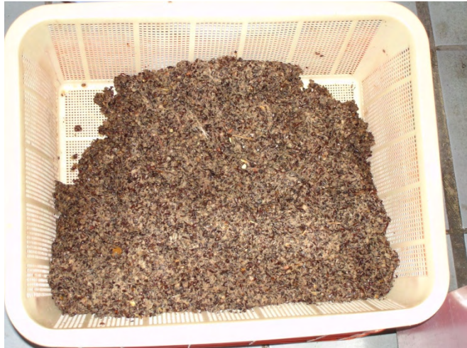
Imagen 5. Drenado de la cascarilla de semilla de algodón.
