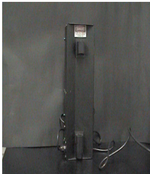
Figura 4.69. -Fuente de poder para tubos de descarga.
