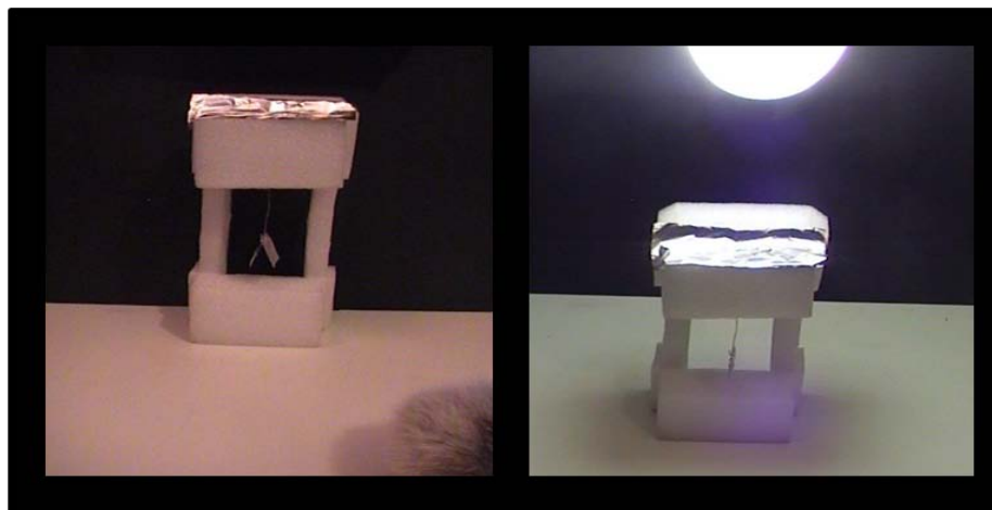
Figura 4.91.- Electroscopio cargado (izquierda) y se descarga con el haz de luz (derecha).
