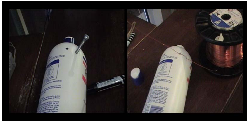
Figura 4.50.- Perfora y sujeta el alambre.
