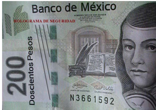
Figura 2.46.- Aplicaciones de la holografía en los billetes. El nuevo billete de doscientos pesos, contiene una franja holográfica en la parte izquierda de la cara de Sor Juana Inés de la Cruz.
