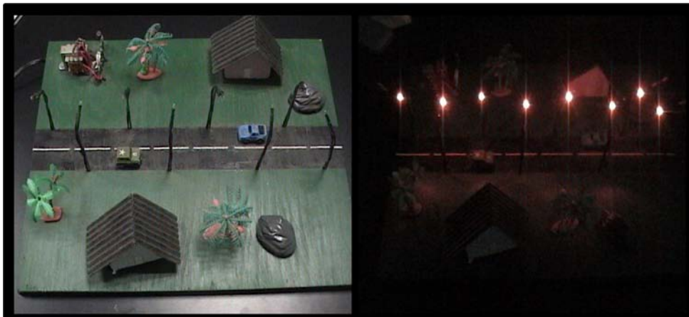
Figura 4.99.- Maqueta que funciona con una fotorresistencia.
