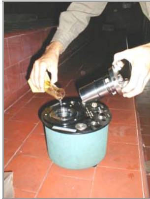
Figura 5.18. Muestra de aceite vertida en la celda y equipo para prueba de factor de potencia.
