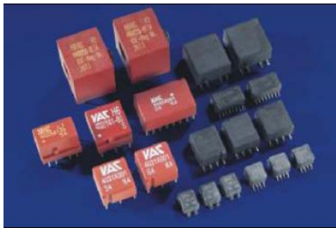
Figura 2.7 Transformadores de Acoplamiento
