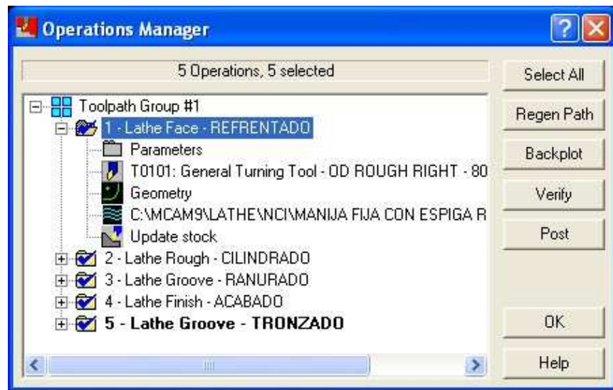
Figura 76. En esta ventana se gestionan las operaciones creadas para el mecanizado.
