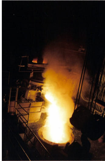
Figura 1.25.- Vaciado del acero a la cuchara (fotografía tomada por el autor de la presente tesis, en la siderúrgica: Metaver, Córdoba Ver.)
