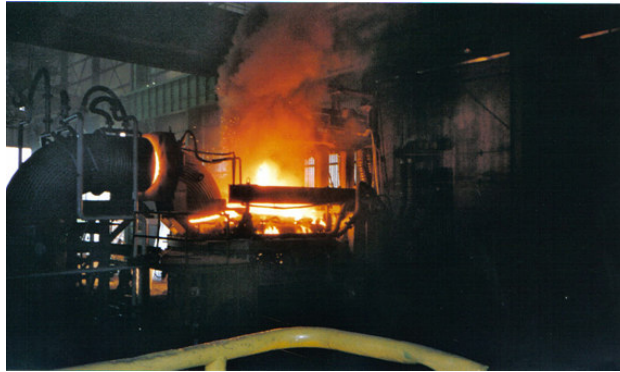
Figura 1.23.- Horno de arco eléctrico durante el proceso de fundición (fotografía tomada por el autor de la presente tesis, en la siderúrgica: Metaver, Córdoba Ver.)
