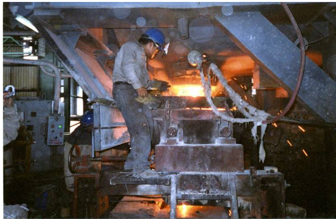
Figura 1.21a.-Vaciado del acero al depósito dosificador de la máquina de colada continua (fotografía tomada por el autor de la presente tesis, en la Siderúrgica: Metaver, Córdoba Ver.)
