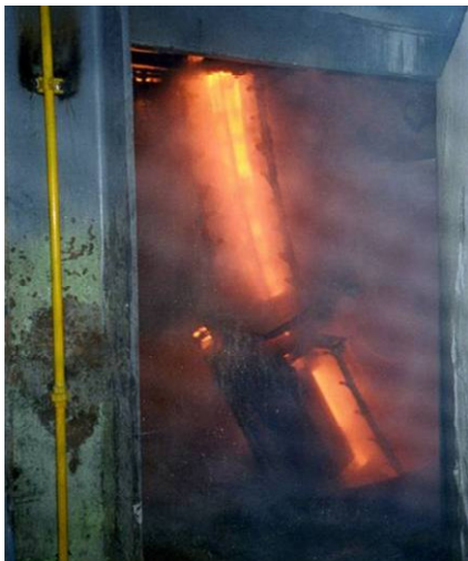
Figura 1.21c.-Cámara de enfriamiento de la maquina de colada continua, fotografía tomada por el autor de la presente tesis, en la Siderúrgica: Metaver, Córdoba Ver.)
