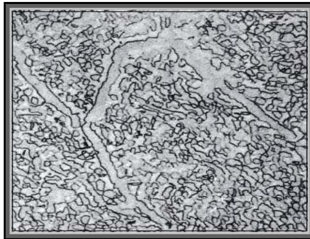
Figura 1.15. Aleación Ti-8Mn, recocida por 2 hr. a 700°C, enfriada en horno a 600°C y mantenida a esa temperatura por 1hr, presenta granos  $\alpha$  (grises) en una matriz  $\beta$  (clara), también  $\alpha$  en las anteriores fronteras de grano  $\beta$ . Atacada químicamente en reactivo de Kroll, 500x.
