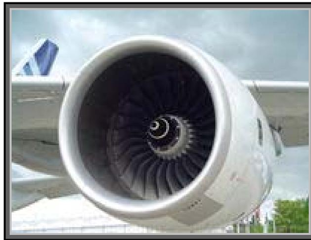
Figura 1.22. Motor de Airbus A-380 con 11 Tm de Titanio
