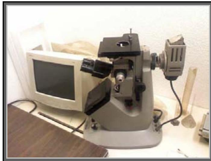
Figura 1.33. Microscopio metalográfico.
