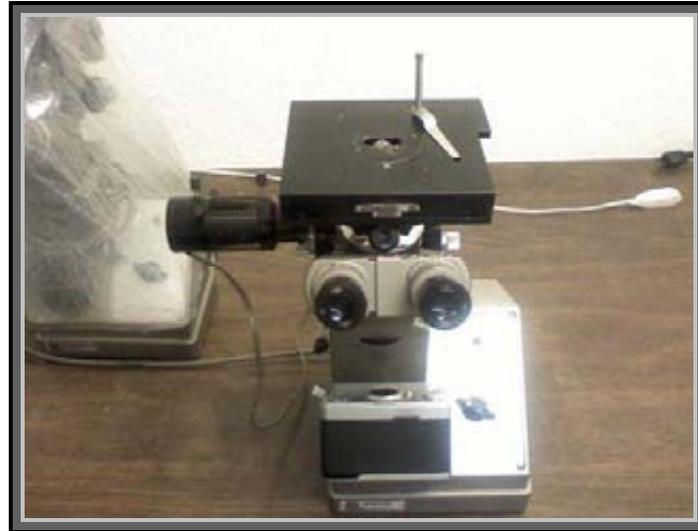
Figura 1.34. Toma de las fotografías a través del Microscopio.
