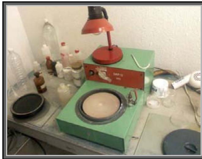
Figura 1.31. Máquina rotatoria para pulir las muestras.
