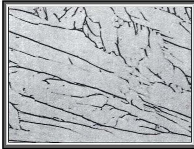
Figura 1.13. Aleación Ti-5Al-2.5Sn trabajada en caliente por debajo de la temperatura de transformación  $\alpha$ , recocida durante 30 min. A  $1,177^{\circ}\text{C}$  superior a la temperatura de transformación  $\beta$ , y enfriada en horno. La estructura  $\alpha$  es gruesa tipo placa. Atacada químicamente en reactivo de Kroll, 100x.
