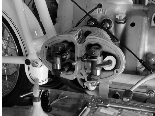
Fotografía 4.2 Detalle de tren de válvulas una vez retirada la tapa de punterías.
