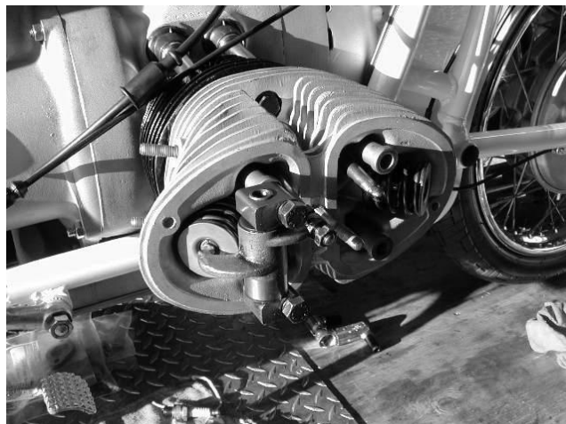
Fotografía 4.3 Detalle de balancín retirado dejando a la vista el resorte de válvula.
