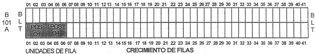
Fig. A I-5 Designación de la posición de los Bastidores Dentro de las Filas.
