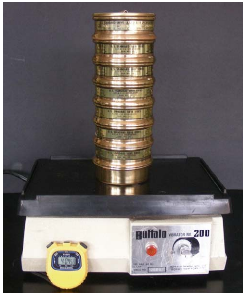
Figura 17. Tamices sobre el vibrador dental.
