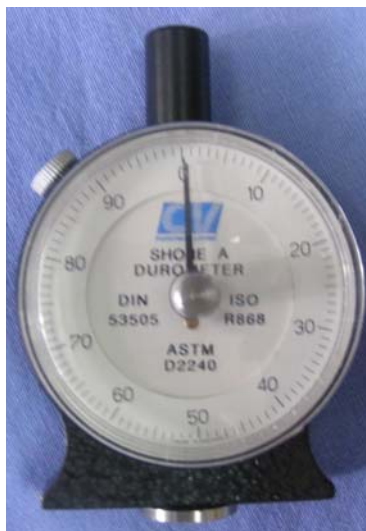
Figura 9. Durómetro utilizado para medir la dureza de las tabletas elaboradas.
