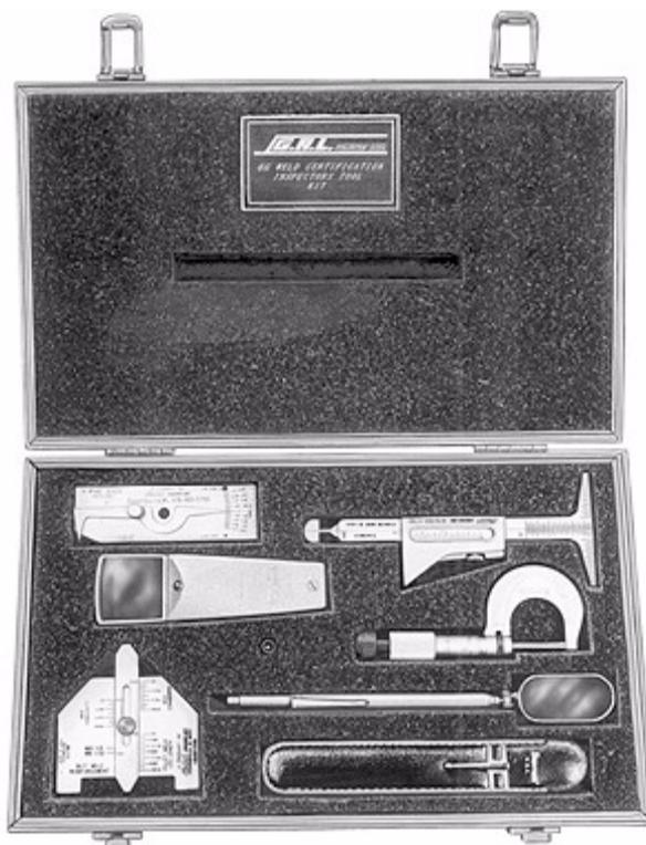
**Figura III.2** Kit para la inspección visual.
