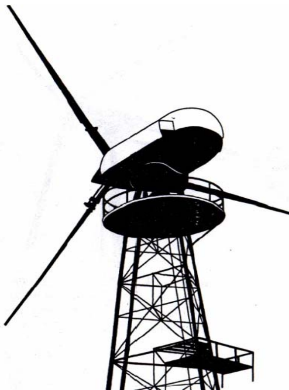
Figura 1.3.4-17. Planta eólica de 100 kW de potencia construida en las islas Orkney (Norte de Escocia) por la compañía John Brown. Fuente: Cádiz. (1984). “La energía eólica, tecnología e historia” 1ED, Hermann Blume.
