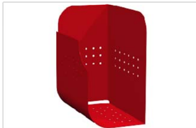
Pieza D del mochilero en lámina cal.20 (0.91 mm), rolada a 90° con un radio de 79mm. y doblada a 90° con acabado en pintura electrostática en color: rojo koi pantone 1795 C (1 pza).
