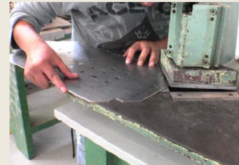
Paso 6. De acuerdo a las plantillas de los refuerzos, se cortan los ángulos de las esquinas de las láminas ▼
