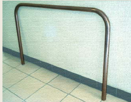
Paso 2. Corte y rolado de los tubos de los barandales de apoyo, de la estructura y los del mochilero ▼
