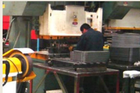
Paso 5. Se cortan las láminas a las dimensiones que indican los planos de producción ▼
