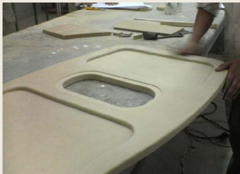
Paso 4. Se lija toda la pieza y los últimos detalles se lijan manualmente
