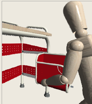
Paso 8. Se ensambla el mochilero a la estructura por medio de las correderas de extensión.
