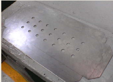
Paso 7. Se marcan las guías de doblez y se hacen los barrenos donde los planos lo indiquen
