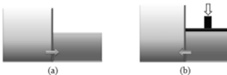
Figura 2.14 Proceso de la ósmosis (a) y la ósmosis inversa (b) [El autor]
