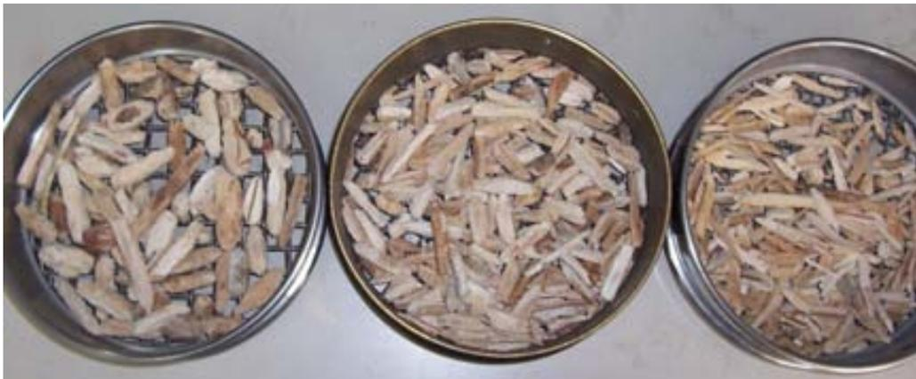
**Figura 3.5 Material retenido en las mallas de 0.0125, 0.00952 y 0.00635 m ( $\frac{1}{2}$ ,  $\frac{3}{8}$  y de  $\frac{1}{4}$  in) respectivamente**
