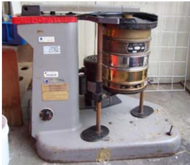
**Figura 3.6 Agitador de tamices**
