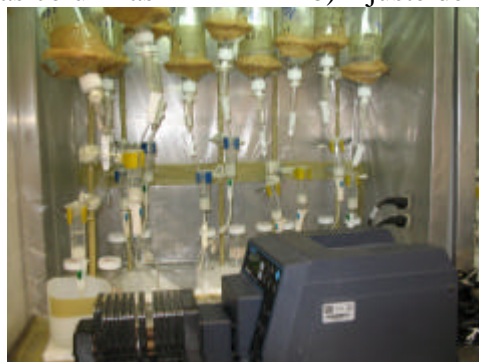
c) Activación de las columnas
