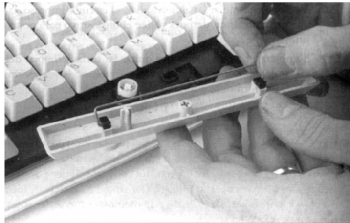
Cómo colocar el alambre de retención.
