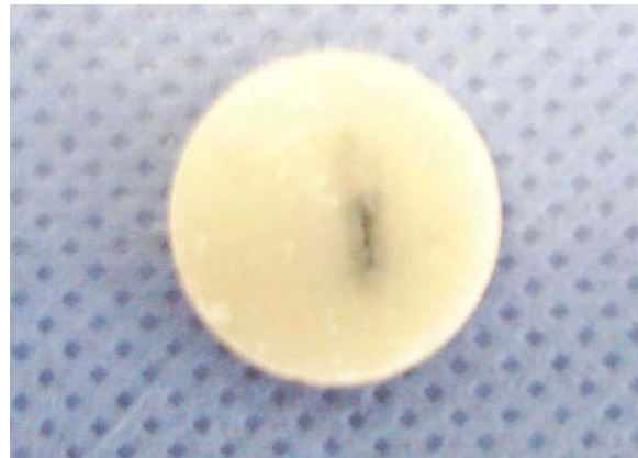
Fig. 53. Muestra semicircular de resina con microchip.
