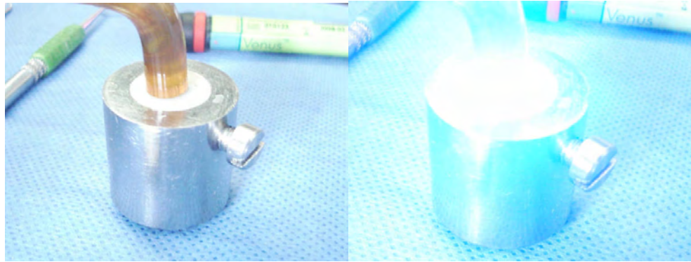
Fig. 51. Polimerización de la muestra de resina con microchip incluido.
