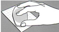
2.3.5 Se presionó suavemente el dispersor para distribuir el inóculo sobre el área circular, cuidando no girarlo ni deslizarlo.
