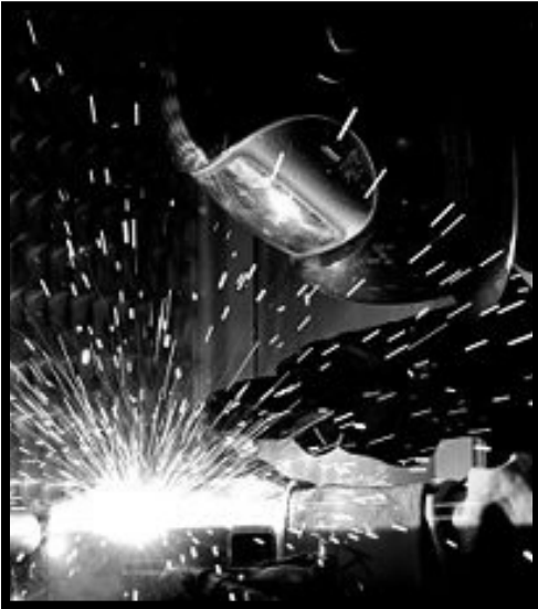
Imagen 123 en la izquierda: Obrero soldador haciendo uso del arco eléctrico para la realización de la soldadura en una pieza. Imagen 124 a la izquierda: Esquema grafico que muestra el proceso detallado de la soldadura mediante la utilización de arco eléctrico. Estas eran algunas de las actividades que se realizaban en la planta No. 2, producto del proceso de modernización que sufrió la empresa tras la fusión en 1960 con Falk Corp. (Fuente: acerera.com)
