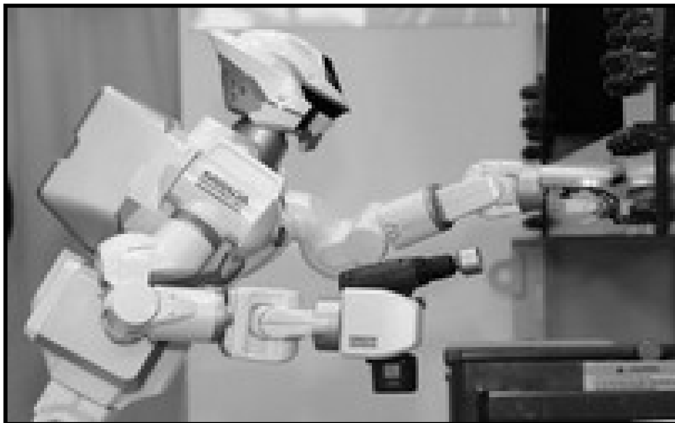
Imagen 229: Prototipo del obrero robot HRP-3 MK II, última invención de un grupo de investigadores japoneses de las empresas Kawada Industries y Kawasaki Heavy Industries (KHI); quienes afirmaron que puede realizar tareas muy agotadoras e incluso peligrosas para el trabajador humano. Este robot cuya medida es de 1.68 metros de altura y pesa alrededor de 68 kilos, es capaz de desplazarse por superficies arenosas e inclinadas y soportar las inclemencias mas extremas, además de que su memoria es capaz de reconocer y utilizar herramientas como desatornilladores, taladros y operar maquinaria avanzada. (Fuente: La tecnología hoy )
