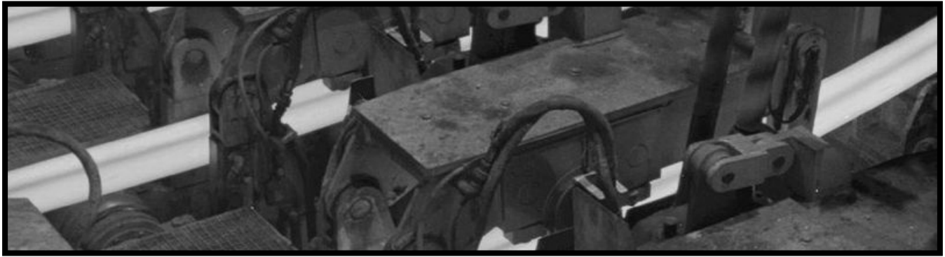
Imagen 118: Proceso de colado continuo para la fabricación de lingotes de acero. (Fuente: wikipedia. )
