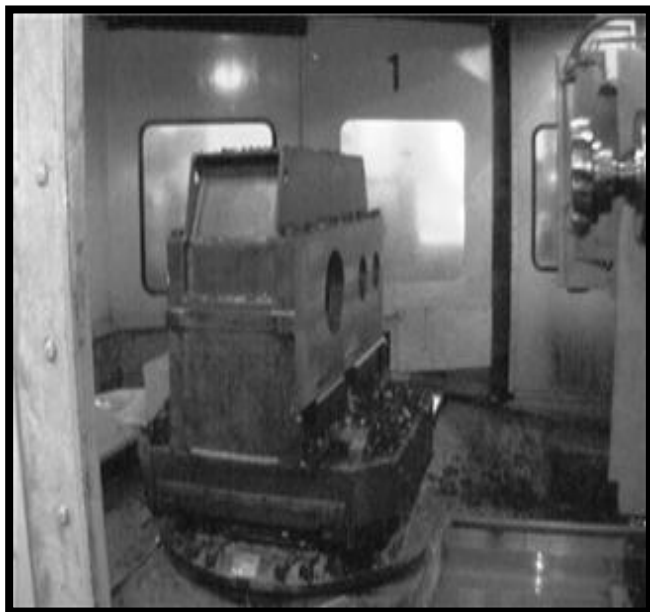
Imágenes 258 y 259: En la izquierda parte interna de la Máquina de Control Numérico Computarizado (CNC). Imagen derecha: exterior de la máquina (CNC) en donde se necesita solamente la programación de una persona, para llevar a cabo el proceso que antes de la Reconversión Industrial en Mecánica Falk SA. D CV. lo ejecutaban 50 trabajadores en promedio. (Fuente: Fotos tomadas por Víctor Vargas González)
