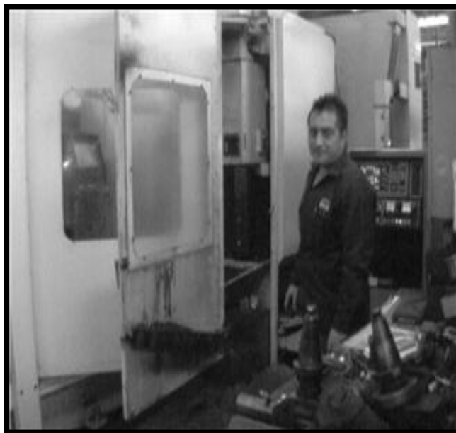
Imágenes 258 y 259: En la izquierda parte interna de la Máquina de Control Numérico Computarizado (CNC). Imagen derecha: exterior de la máquina (CNC) en donde se necesita solamente la programación de una persona, para llevar a cabo el proceso que antes de la Reconversión Industrial en Mecánica Falk SA. D CV. lo ejecutaban 50 trabajadores en promedio. (Fuente: Fotos tomadas por Víctor Vargas González)
