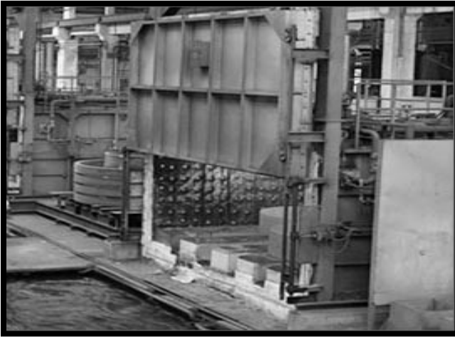
Imagen 137: Fotografía de un Horno cuyo uso eficaz en el tratamiento térmico, permite que el proceso sea acelerado debido a que mantienen la uniformidad de la temperatura y la ausencia de oxidación, dando con ello la facilidad de manejo de los mismos. Imagen 138: En la derecha, fotografía del horno térmico del área de producción de la Empresa. (Fuente: Víctor Vargas)
