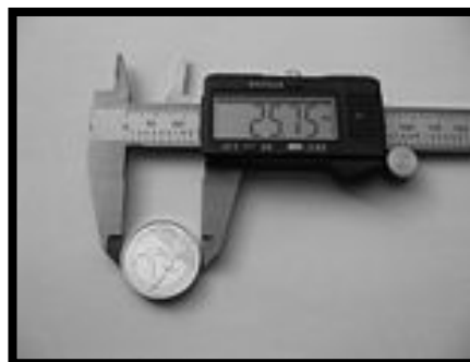
Imágenes 141, 142: En la izquierda, broca de corte vertical que se implementa en una taladradora vertical. En la derecha un calibrador pie de rey digital. (Fuente: wikipedia)
