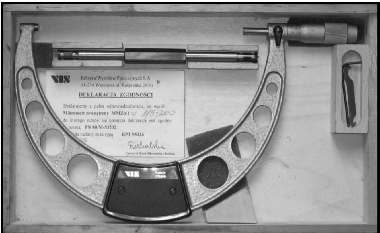
Figura 147: Abajo un micrómetro para exteriores (175-200) utilizado para la verificación de los engranajes. (Fuente: Herramientas manuales y de precisión)
