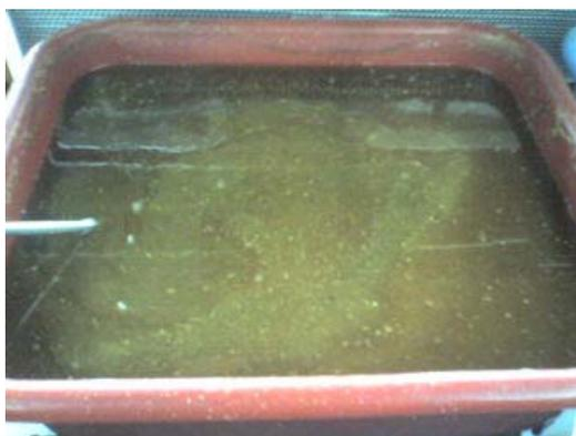
Figura 13: Harina de ejote de *E. americana*, cubierta con solución de HCl al 1%.
