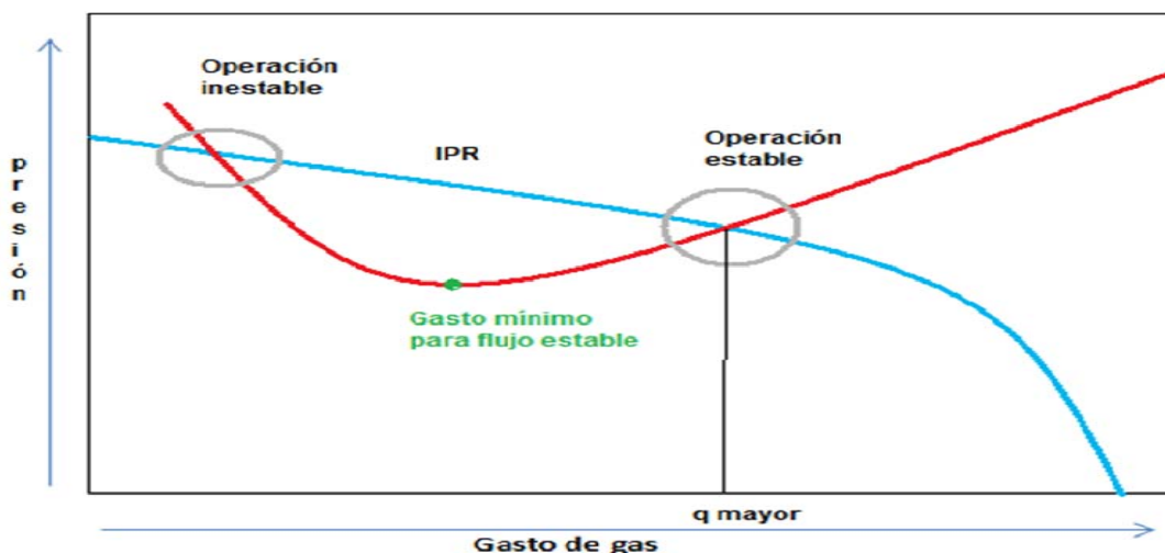
Figura 3.7 Curva del comportamiento de flujo en la tubería en relación con el IPR.
