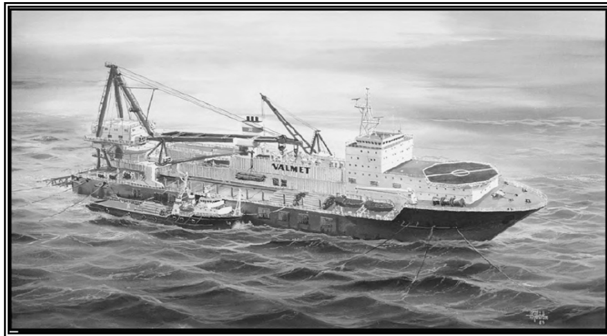
Figura III.6 Tendido de la tubería con barco
