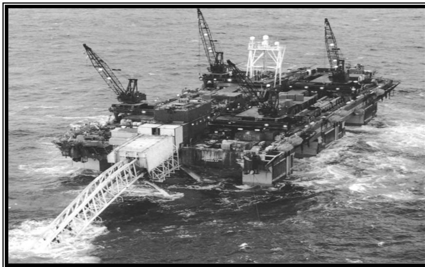
Figura III.5 Tendido de la tubería con barcaza convencional
