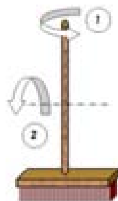
Fig. 18 (C.I.STR.1). - ¿Cuál de estos giros se haría con más dificultad? En ② el momento de inercia es mayor.
