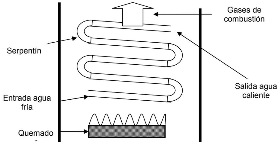
**Figura 5. Esquema de un calentador de paso instantáneo.**
