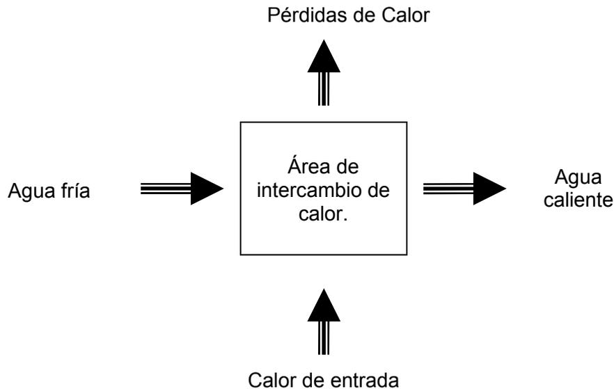
**Figura 1. Principio básico del intercambiador de calor.**
