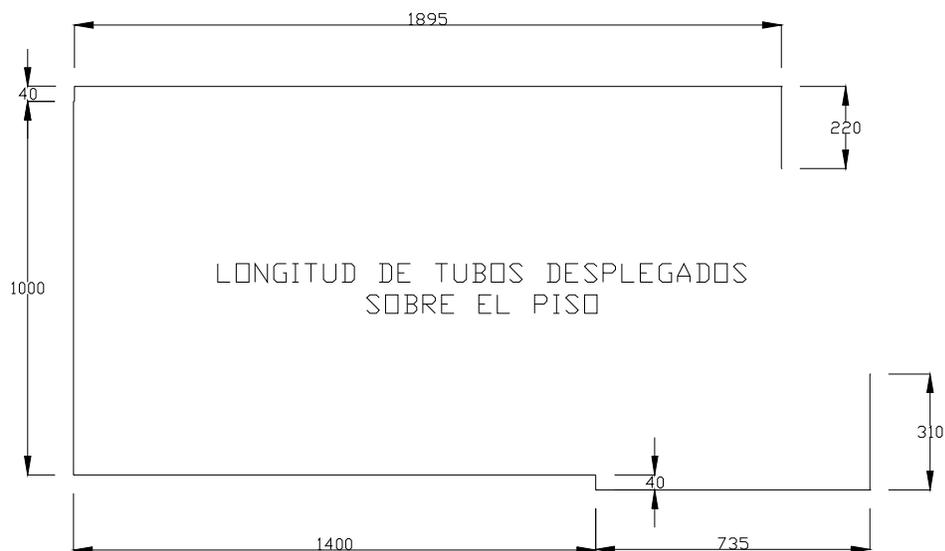
**Figura 17. Arreglo de precalentador solar tipo radiador.**
