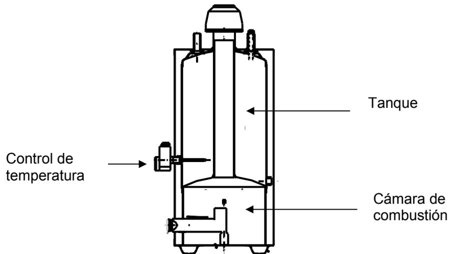
**Figura 3. Calentador para agua de depósito.**
