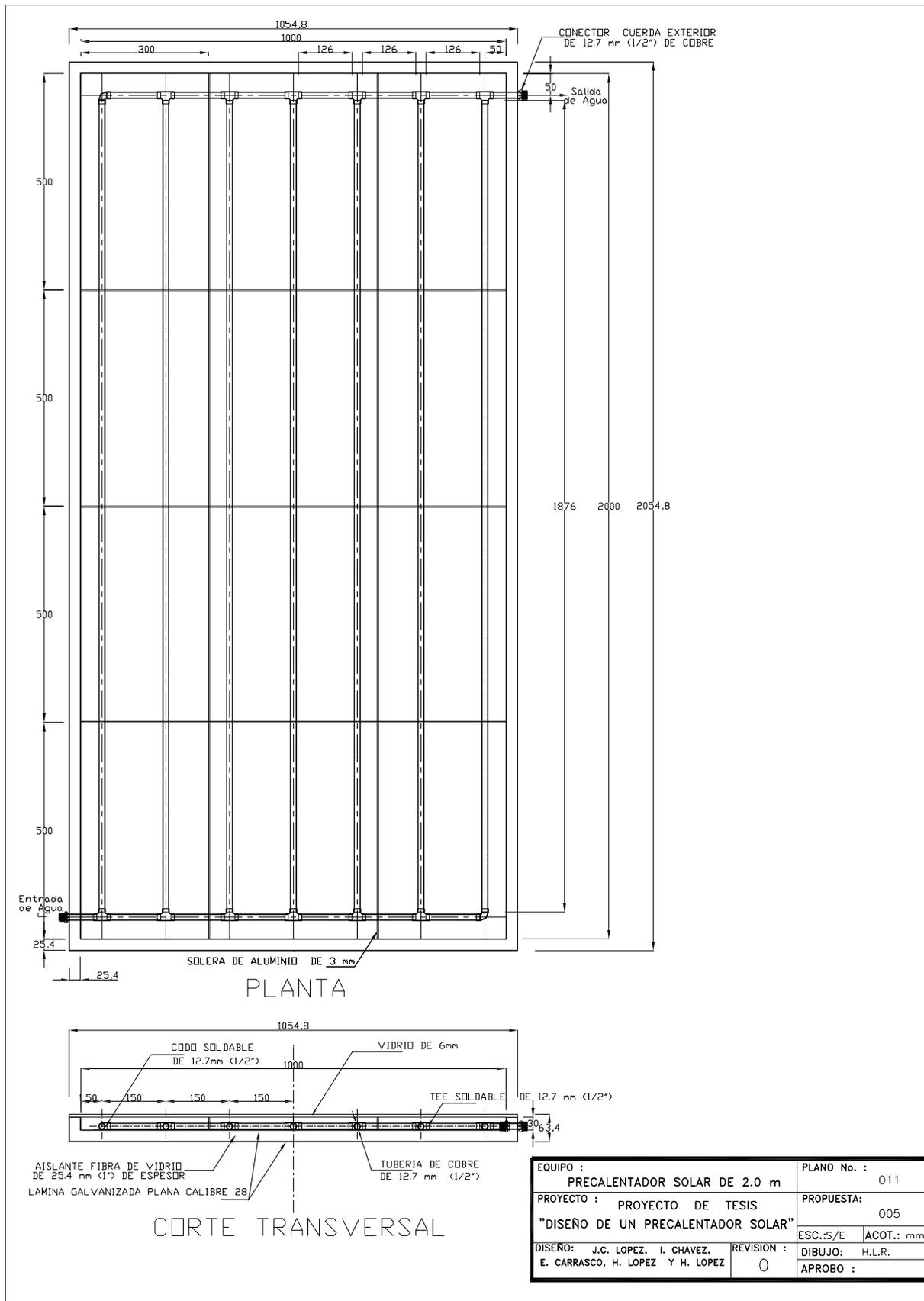
Figura 13. Comparativo tipo radiador con área de captación de 2 m<sup>2</sup>.
