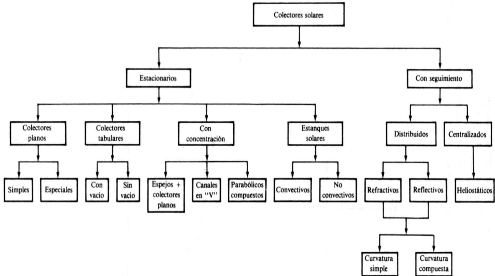
Figura 6. Colectores para sistemas solares de conversión termodinámica.
