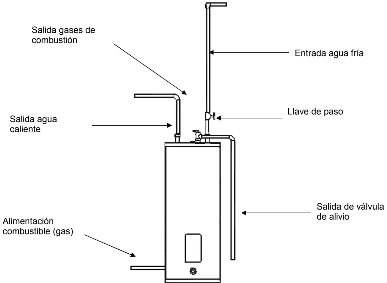
**Figura 2. Diagrama de instalación de un calentador.**
