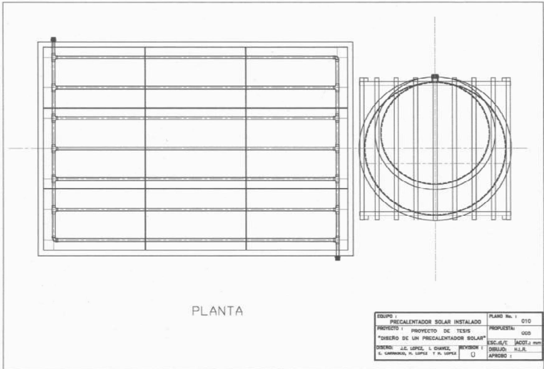
Figura 28. Vista superior del precalentador y tanque instalados.
