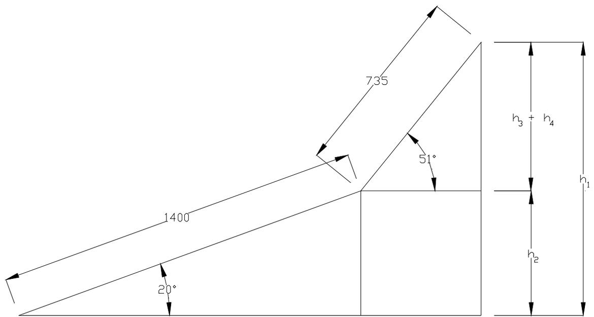
**Figura 14. Dimensiones de la instalación del precalentador solar.**
