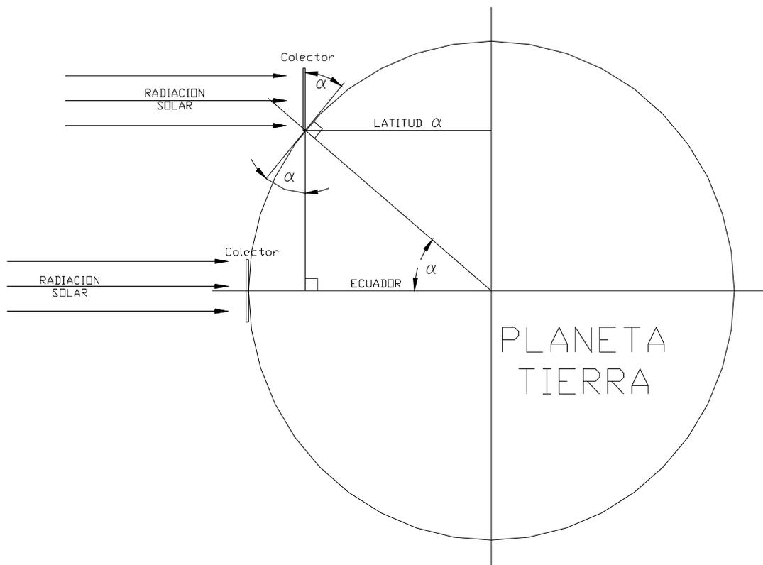
**Figura 29. Radiación solar y ángulo de inclinación.**
