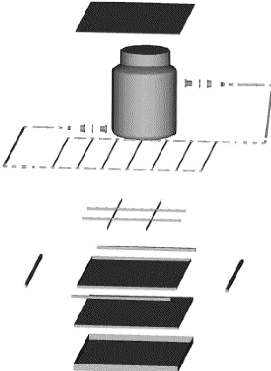
Figura 19. Vista en explosivo del colector y sus elementos.
