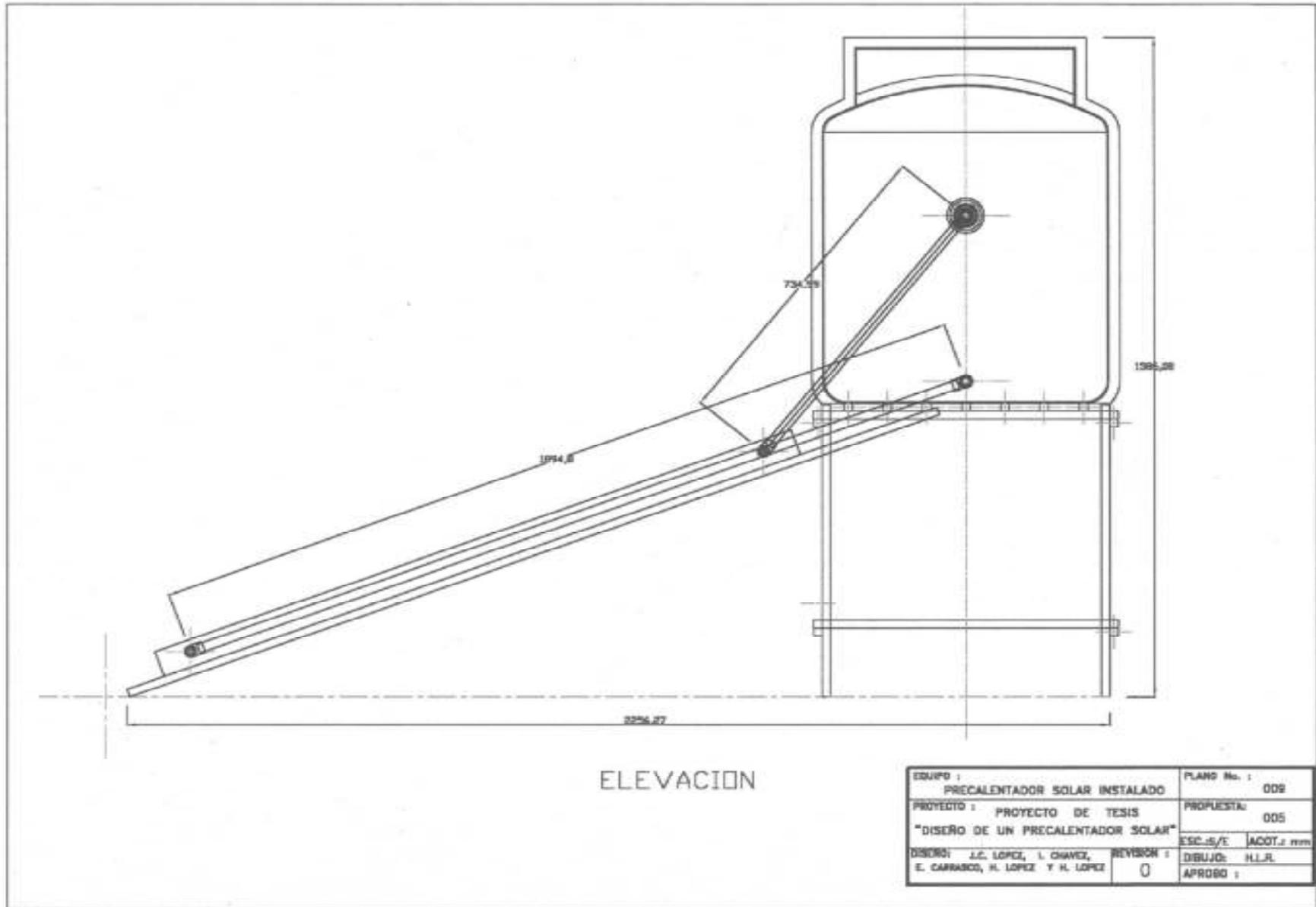
Figura 27. Dimensiones del precalentador y tanque instalados.
