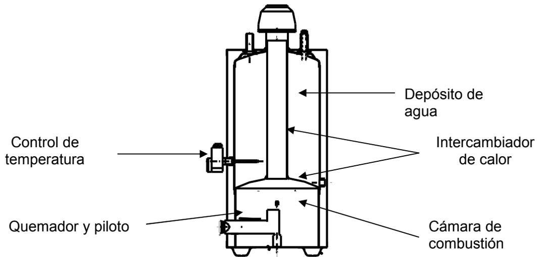
**Figura 2. Componentes básicos de un calentador.**
