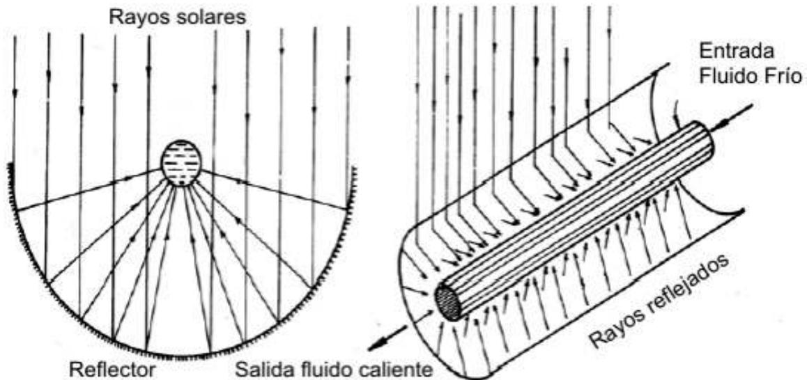
**Figura 9. Colector tipo parabólico y colector tipo cilíndrico<sup>6</sup>.**
