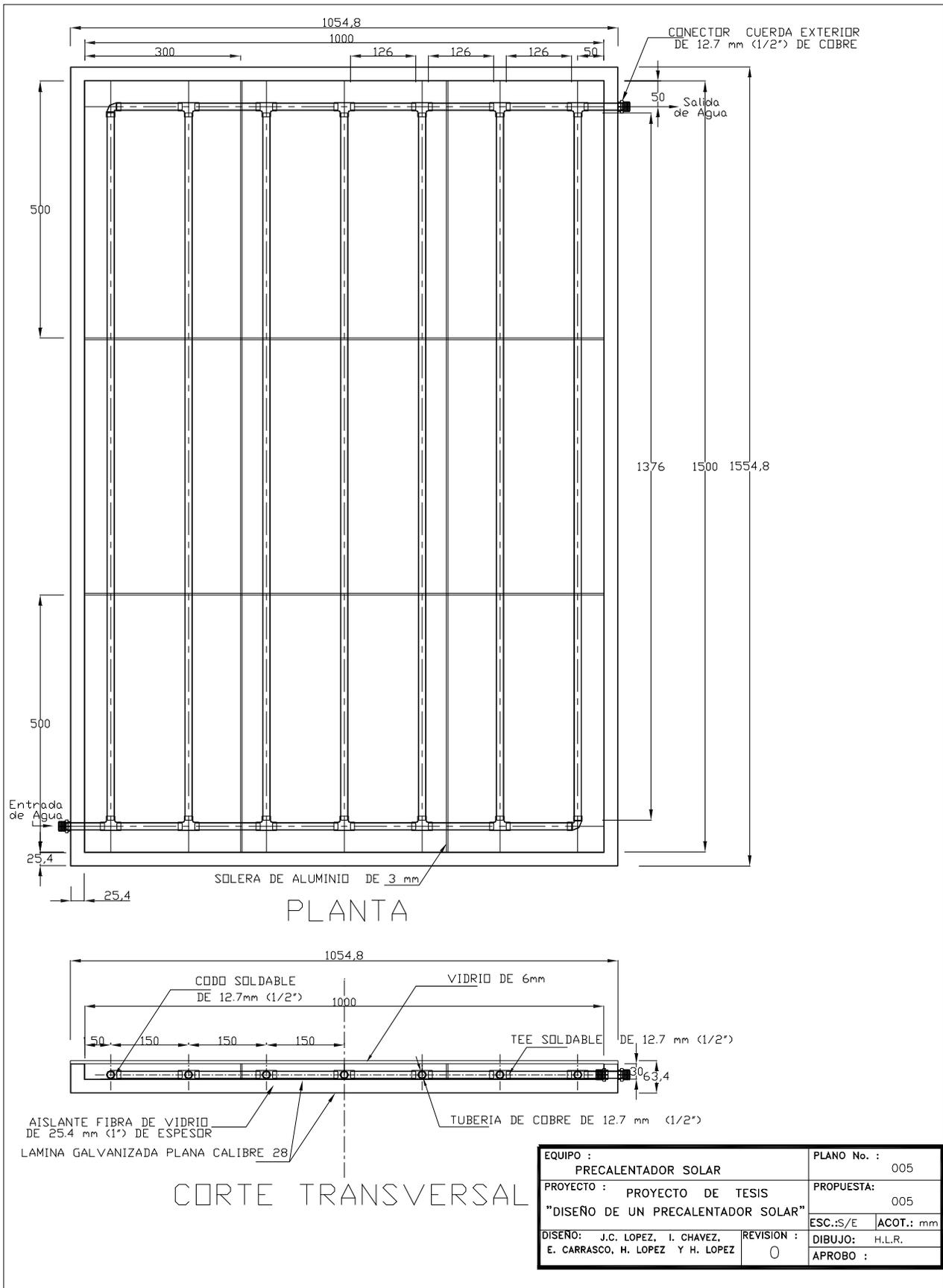
Figura 12. Propuesta tipo radiador con área de captación de 1.5 m<sup>2</sup>.
