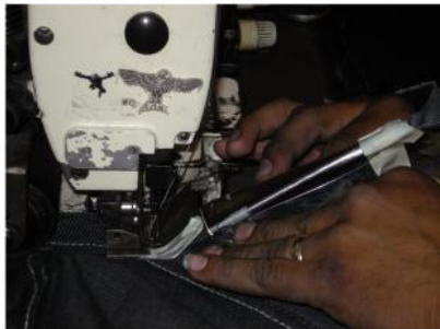
COLOCACION DE PRETINA
