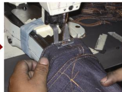
COLOCACION DE PRE-SILLAS PARA TERMINADO DE TRABAS
