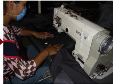
COLOCACION DE SEGUNDA COSTURA
