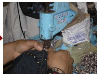
COLOCACION DE METALES (BOTONES, REMACHE, ESTOPE, ROLÉS)
