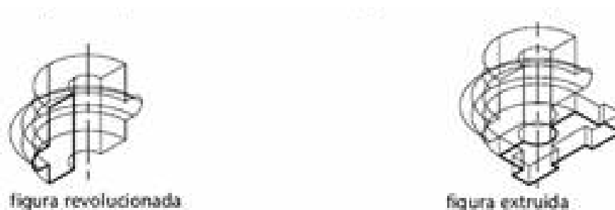
Figura 3.1.1.5.- Principales operaciones para construir una pieza.
