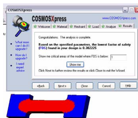
Figura 5.6.1.18.- Áreas críticas del diseño donde el factor de seguridad está por debajo de 1.
