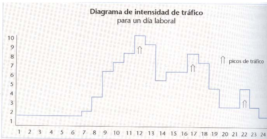
Figura III.27.- Diagrama de Intensidad de Tráfico para un Día Laboral.
