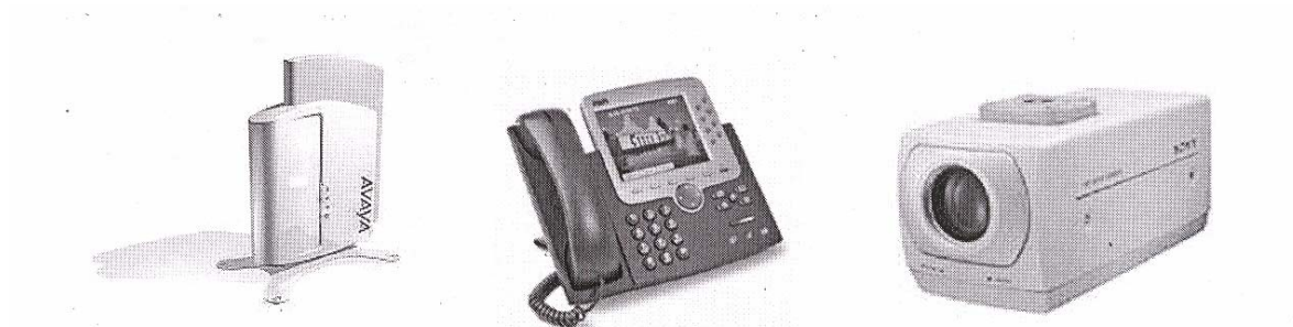
Figura II.21.- Diferentes Equipos que pueden ser utilizados en P o E. Éstos son (de izquierda a derecha): Avaya™ AP-5 WLAN AP; Cisco™ 7970 IP Phone y Sony™ SNC-Z20N Net Camera.
