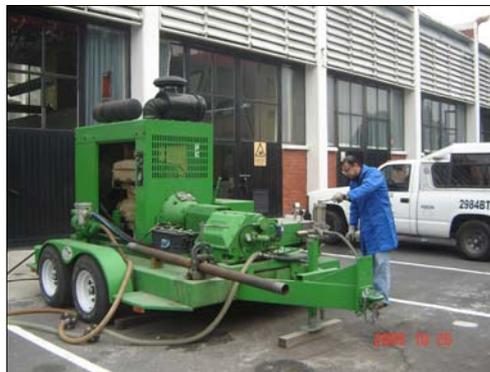
**Fig. 4.20 Prueba de Hermeticidad en el Laboratorio del IMP**
