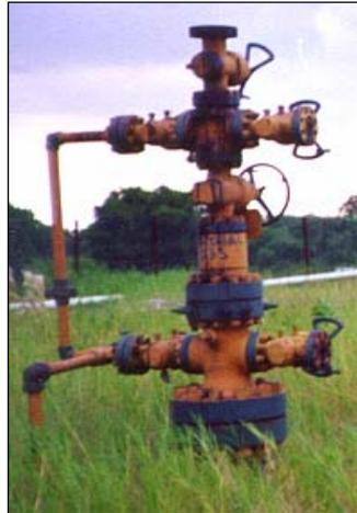
**Fig. 1.11 Árbol de válvulas usado en un pozo donde se utiliza BN.<sup>6</sup>**
