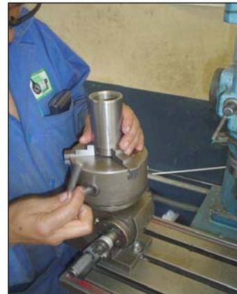
**Fig. 4.13 Fijación de la pieza**
