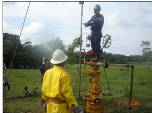
**Fig. 5.5** Empiezan a subir la Herramienta pasando por los lubricadores
