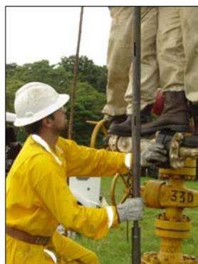
**Fig. 5.8** Herramienta introduciendo al pozo, previamente engrasada
