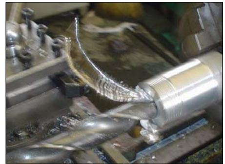
**Fig. 4.9 Elaboración de la Perforación**
