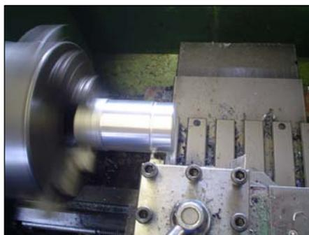
**Fig. 4.4 Cilindrado Exterior**
