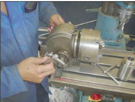
**Fig. 4.12 Ajuste de Cabezal Divisor**
