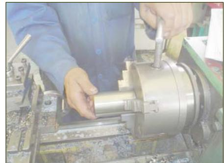
**Fig. 4.2 Sujeción en el Torno**
