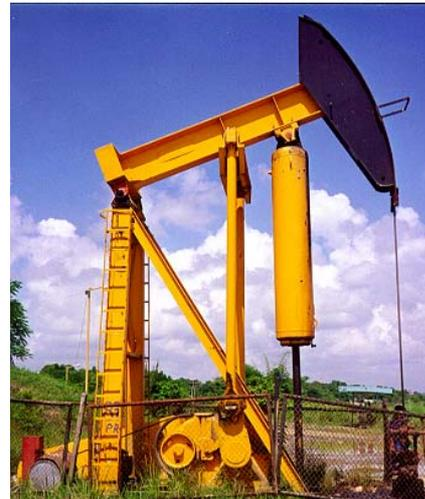
**Fig. 1.10 Equipo superficial usado en Bombeo Mecánico.<sup>6</sup>**
