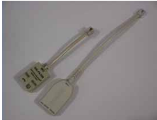
Figura III.18.2.g. Filtro Splitter utilizado para interconectar terminales de cómputo y telefónicas.
