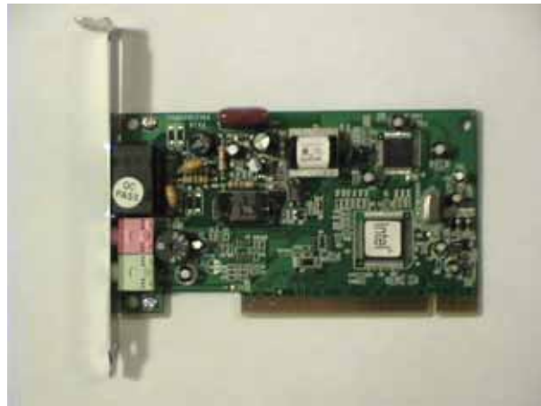
Figura III.17.2.a. Módem interno, actúa de manera Síncrona con la computadora.
