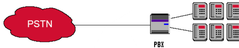
Figura III.8.c. Sistema de PBX.
