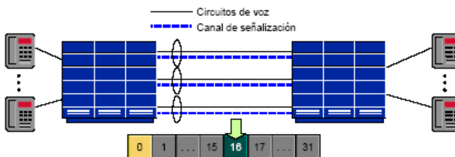
Figura III.11.1.a. Señalización por Canal Asociado.
