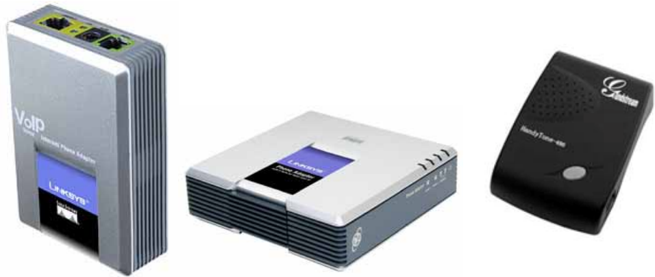
Figura IV.3.3.a. Gateways aplicados para Telefonía sobre IP.
