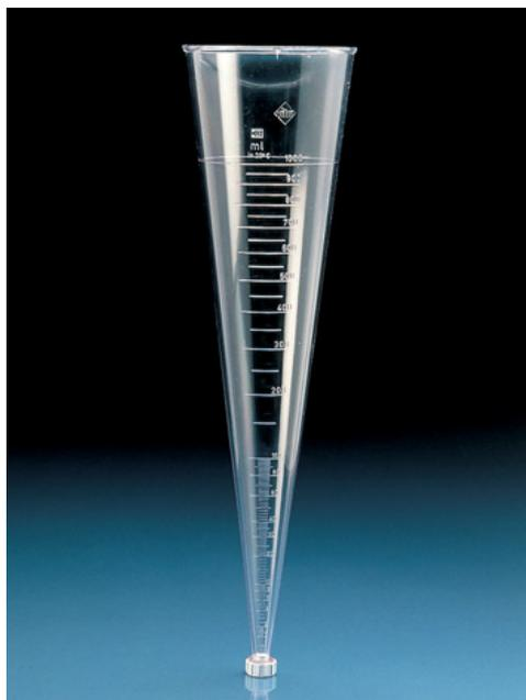
Figura 3.2 Cono de sedimentación (Imhoff)
