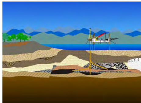
Figura 1.7 Múltiples pozos con una misma plataforma.
