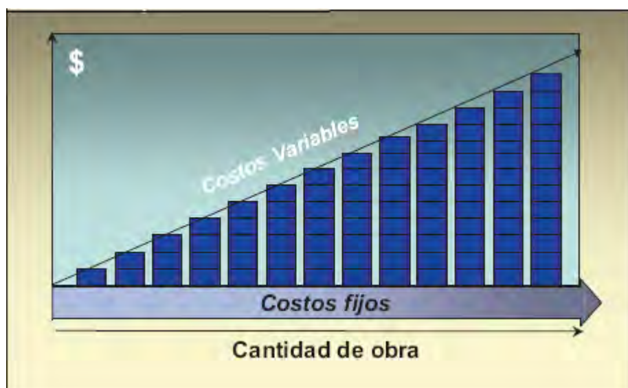
Figura 5.2 comportamiento de la relación entre costos fijos y variables y la distribución de costos dependiendo de la obra.
