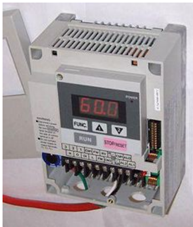
Fig. 2.9 Variador de velocidad.
