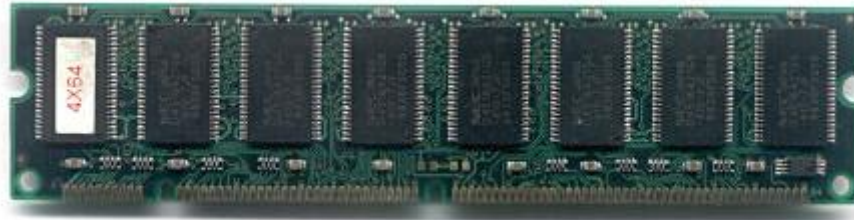
FIGURA 1.16. MEMORIA TIPO DIMM.
