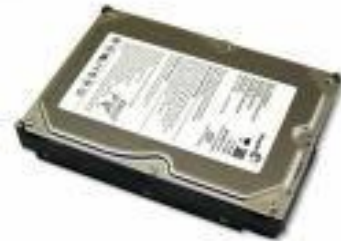
FIGURA 1.22. DISCO DURO DE UNA PC.
