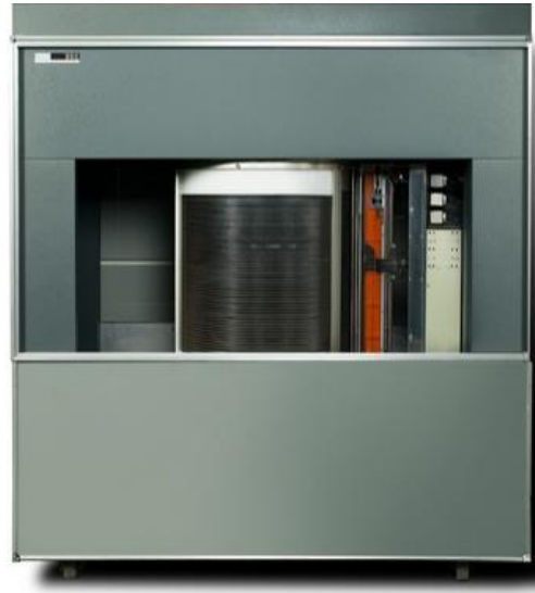
FIGURA 1.21. GABINETE DEL RAMAC-305.
