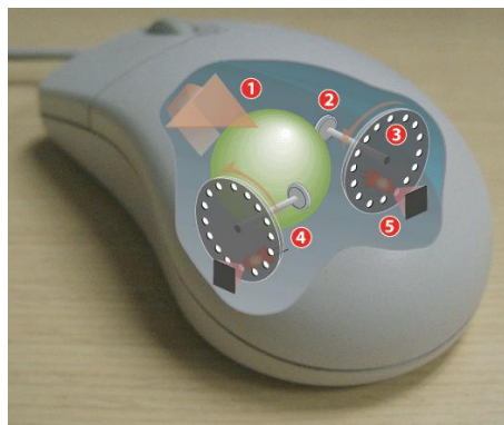
FIGURA 5.12. FUNCIONAMIENTO DEL MOUSE INTERNO.
