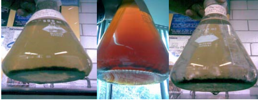
Figura 4.3. (a) Cultivo de bacterias sulfato-reductoras con agua residual “sintética”, (b) Cultivo de bacterias sulfato-reductoras con vinazas y efluente de la planta minera, (c) Cultivo de bacterias sulfato-reductoras con efluente de la mina (fue inoculado con las bacterias proliferadas en los tubos de ensayo)
