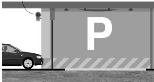
Al detectar la llegada de un vehículo, el sistema comprueba que la plataforma esté libre, si es así se abre la persiana de entrada.<sup>26</sup>
