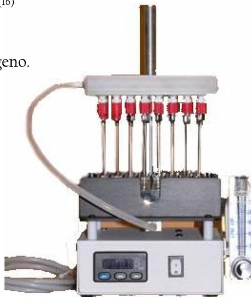
Figura 1.3. Evaporador con Corriente N<sub>2</sub>
