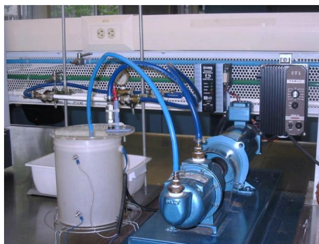
Fig 8.1 Módulo de filtración a escala laboratorio, comprendido por una bomba peristáltica, tanque de recirculación, membrana de ultrafiltración de PVDF de 20 cm y un controlador.
