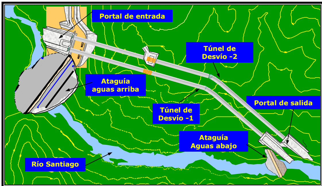
Figura 2.1. Planta general de las obras de desvío.
