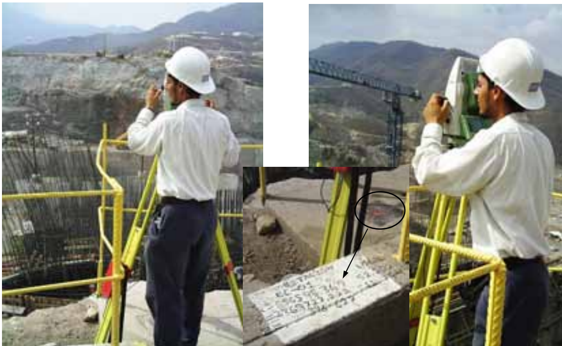
Fotografías 9 y 10. Mojonera EC-01, ubicada en la margen derecha de la zona de control.
