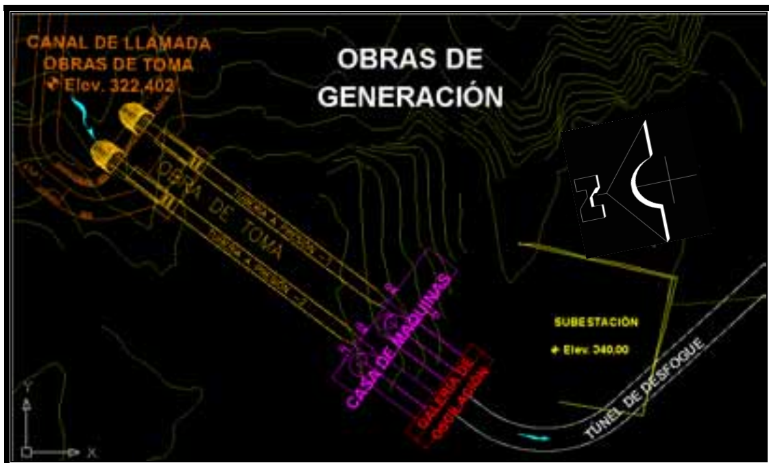
Figura 4.1. Planta general de las Obras de Generación.
