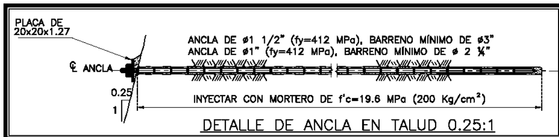
Figura 5.28. Anclas empleados en los taludes de ambas márgenes del vertedor.
