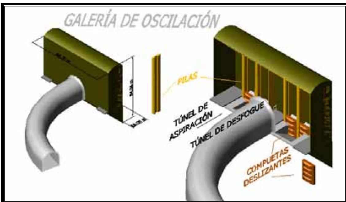
Figura 4.11. Vista general de la galería de oscilación y de los túneles de aspiración.
