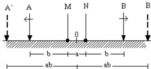
Figura 6. Los electrodos A y B se abren progresivamente mientras que M y N se mantienen fijos
