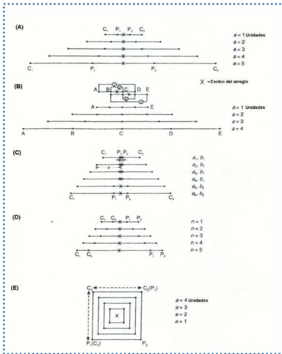
Figura 17. Arreglos expandidos con posiciones de electrodos sucesivas para arreglos de: (A) Wenner, (B) Wenner offset, (C) Schlumberger, (D) dipolo-dipolo y (E) cuadrado.
