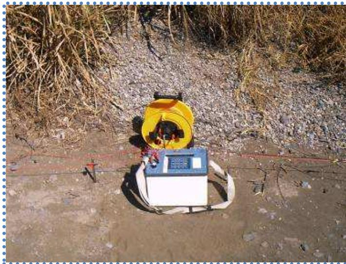
**Figura 20. Equipo Utilizado durante el levantamiento: Syscal R1 Plus.**
