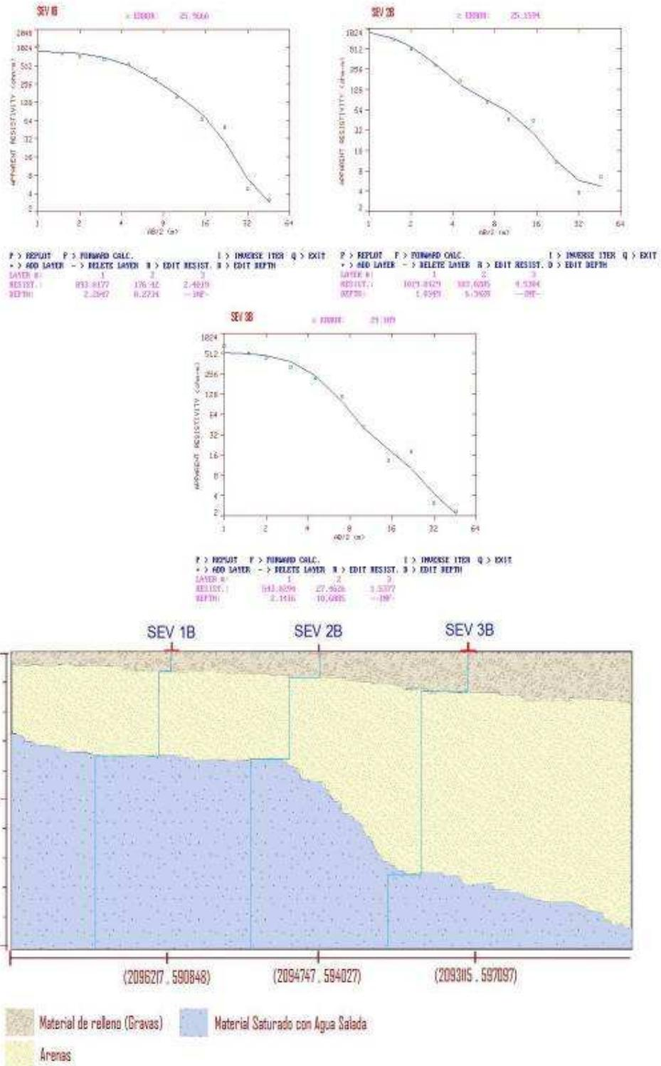
Figura 29. Sección Geológica Barrera de Arena, Inferida a partir de Sección Geoeléctrica.
