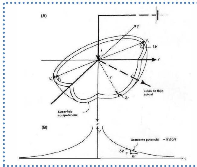
**Figura 10. Representación tridimensional de una cascaron equipotencial alrededor de un electrodo puntual sobre un medio homogéneo semi-infinito (A). El potencial decae al aumentar la distancia de la fuente puntual.**
