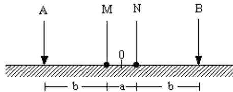
**Figura 21. Esquema representativo del arreglo Schlumberger. A y B electrodos de corriente, M y N electrodos de potencial.**
