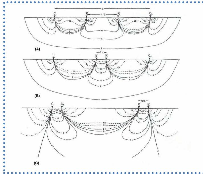
**Figura 14. Secciones de contribución de señal para configuraciones de (A) Wenner, (B) Schlumberger y (C) dipolo-dipolo.**
