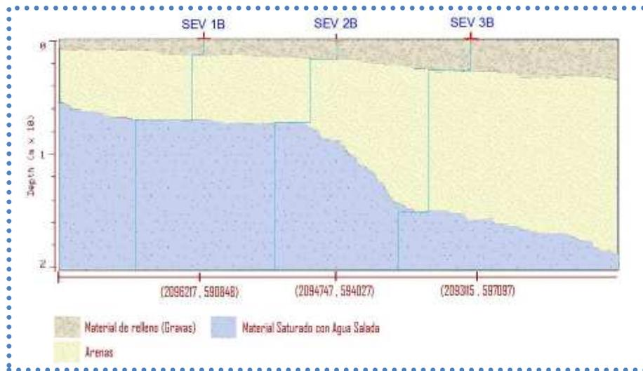
Figura 39. Corte geoelectrico en base al perfil 1 en la zona de la Barrera de Arena.
