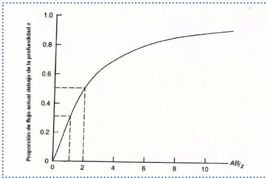
Figura 12. Proporción de corriente que fluye en el subsuelo a una profundidad  $z$  (m).
