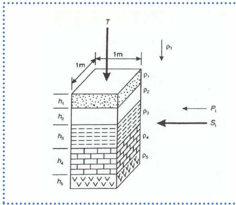
Figura 15. Espesores (h) y resistividades (r) reales de una secuencia estratigráfica y representación esquemática de los parámetros de Dar Zarrouk.
