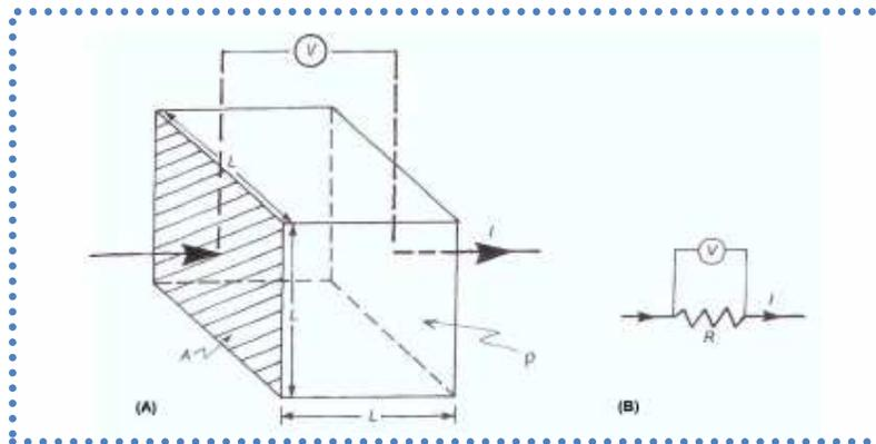
**Figura 8. Definición básica de la resistividad a través de un cubo homogéneo.**
