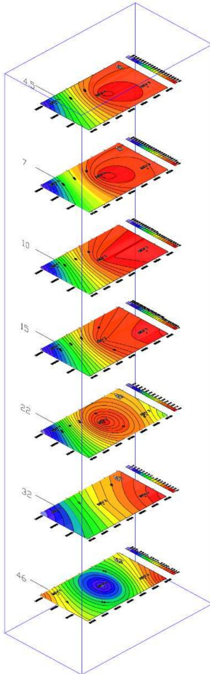
Figura 24. Mapas de iso-resistividad para “Barra de Arena”, colocados de acuerdo a abertura  $AB/2$ .
