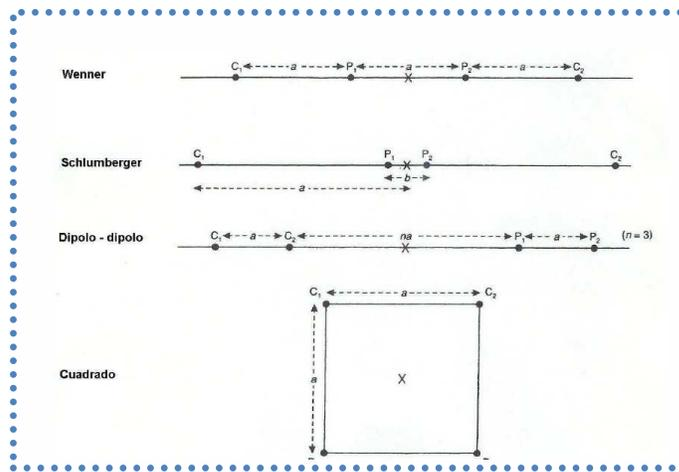
Figura 13. Configuraciones más comunes usadas en levantamientos eléctricos.
