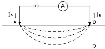
*Figura 1. Aplicación de corriente eléctrica al terreno*
