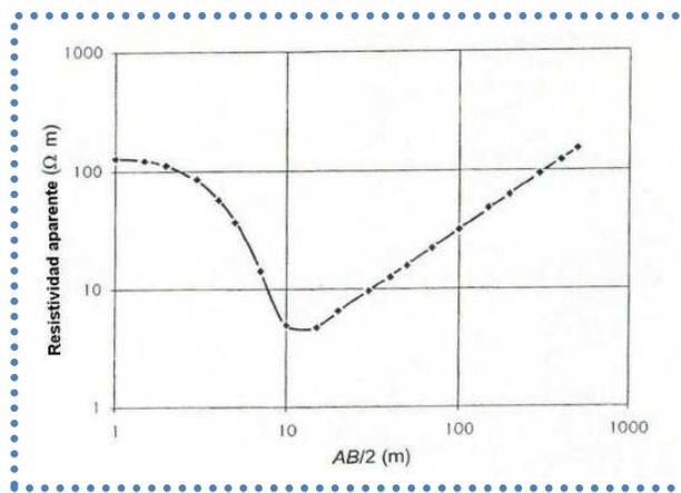
Figura 16. Sondeo eléctrico vertical (SEV) que muestra la resistividad aparente en función del espaciamiento medio del dipolo de corriente.
