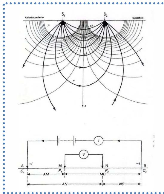
**Figura 11. Líneas de corriente y equipotenciales producidas por dos electrodos (a). Forma generalizada de una configuración de dos electrodos para levantamientos de resistividad (b).**
