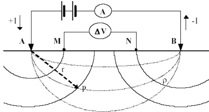
Figura 4. Dispositivo tetraelectrónico para determinar la resistividad del subsuelo
