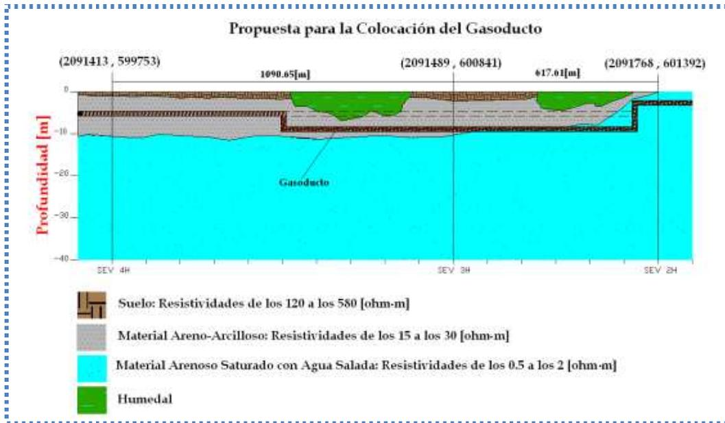
Figura 43. Esquema propuesto para el direccionamiento del gasoducto en la zona del humedal.
