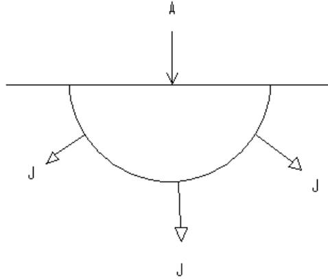
Figura 2. Vector densidad de corriente en semiespacio homogéneo con electrodo puntual en la superficie límite
