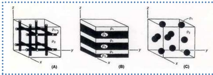
**Figura 9. Tres medios que involucran dos materiales con resistividades diferentes. En estos medios, la conducción eléctrica está influenciada en gran medida por la geometría de las estructuras.**
