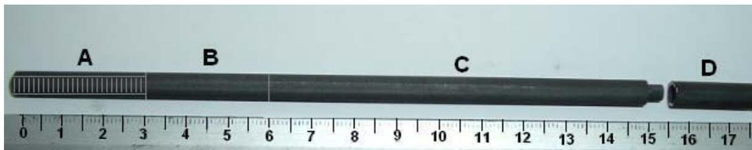
Figura 3.2. Crisol de grafito: A) Base de ensamble con la barra guía, B) Zona sólida disipadora de calor, C) Cuerpo principales del crisol donde se funde la carga, D) Tapa del crisol.
