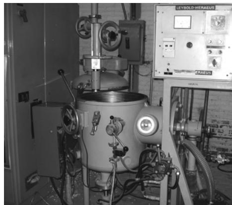
Figura 3.4. Horno de inducción con cámara de vacío utilizado en la preparación de las aleaciones maestras.
