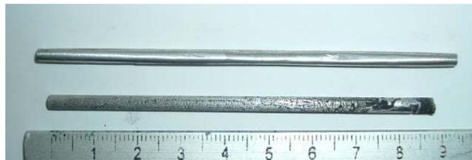
Figura 3.6. Aleación maestra utilizada en los experimentos de solidificación unidireccional
